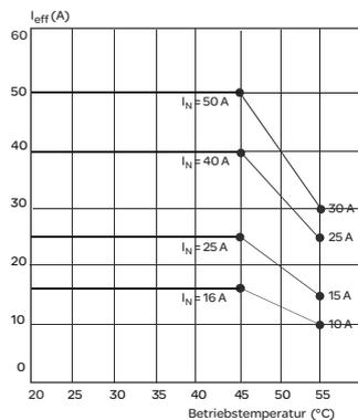
Laststrom in Abhängigkeit von der Umgebungstemperatur
