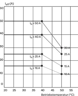
Laststrom in Abhängigkeit von der Umgebungstemperatur
